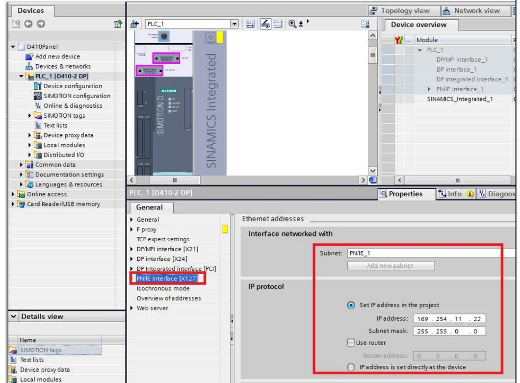
4 双击目录树中“ SIMOTION configuration” 条目，打开 SIMOTION SCOUT TIA 配置软件进行 SIMOTION 的组态及编程:
